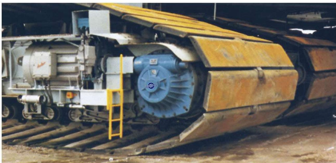
Reductor planetario accionando una oruga pesada.
