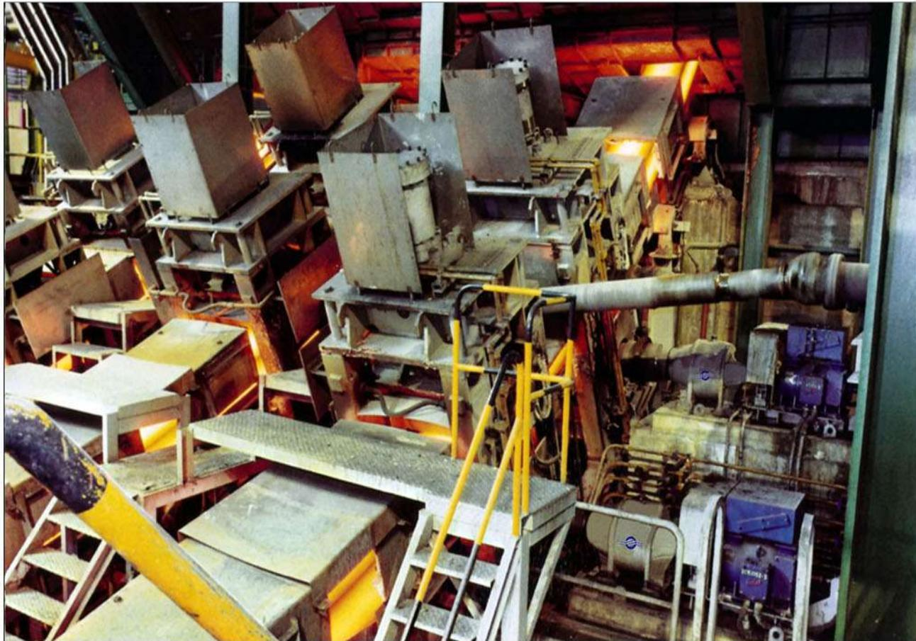
Reductores planetarios FELLAR para accionamiento de pinch roll de c.c. de blooms.
