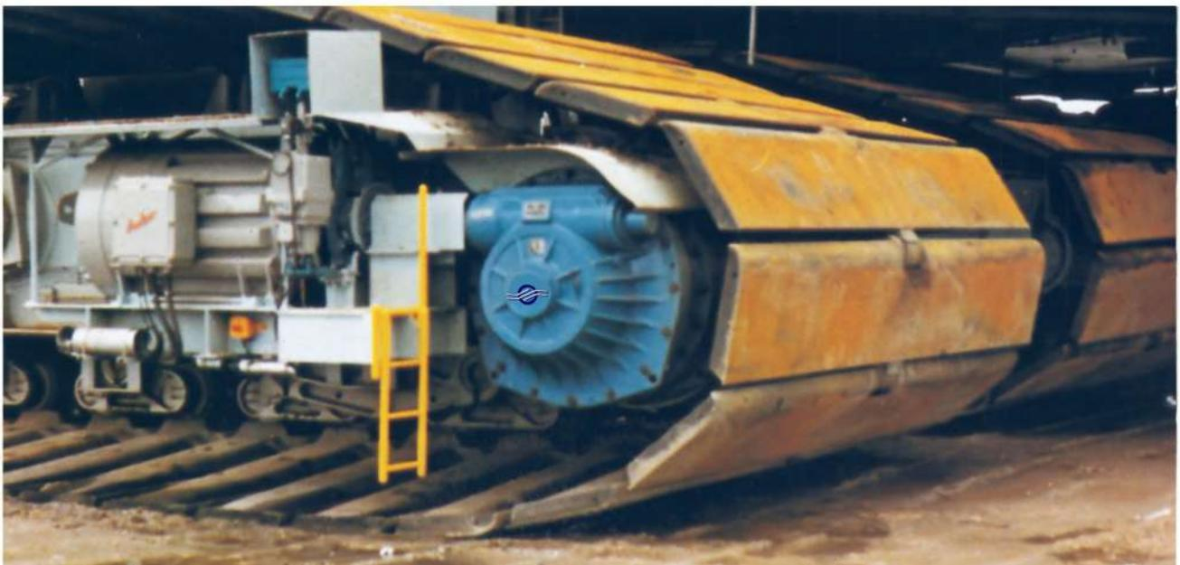
Reductor planetario accionando una oruga pesada.
