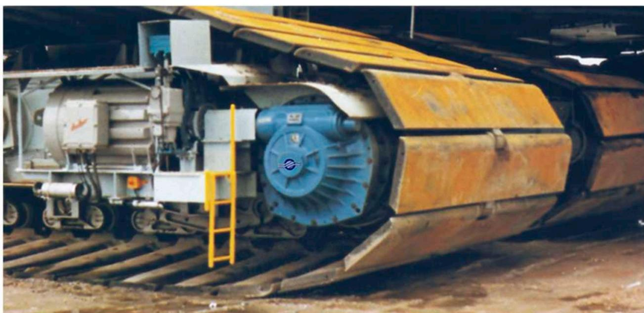
Reductor planetario accionando una oruga pesada.
