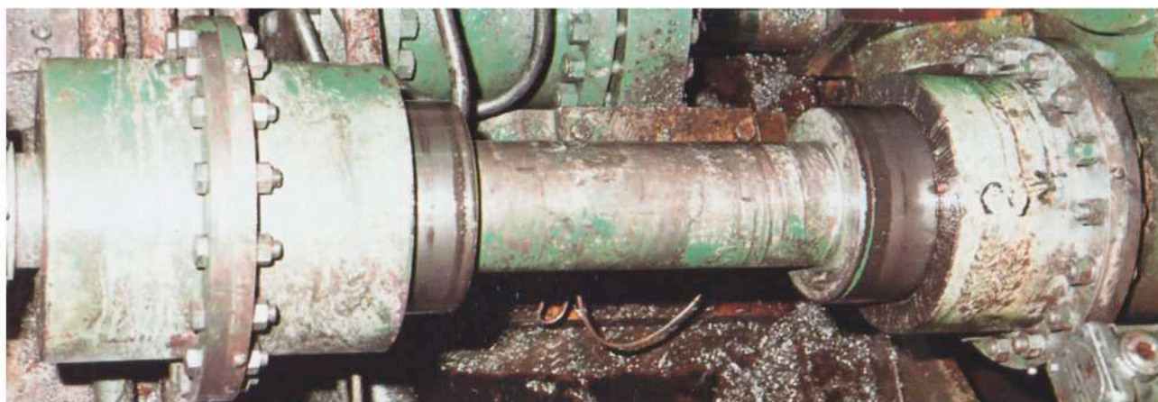
Acoplamiento tipo 1000-D, accionando un tren de laminación en frío.
